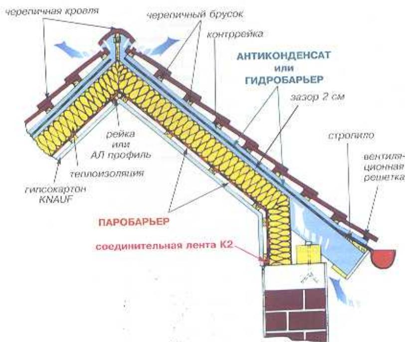
зовнутрь и одновременно обладать как можно большей паропроницаемостью, чтобы способствовать прохождению пара сквозь нее наружу. Показатель паропроницаемости у гидроизоляции достигает обычно 40 г/кв.м/сутки.
